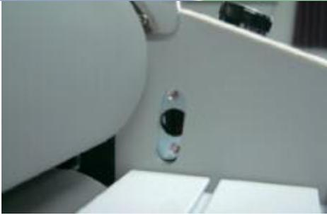
Датчики для обеспечения безопасности пользователя и предотвращения ошибок в работе оборудования, при попадании во время ламинирования в ролики посторонних материалов.
