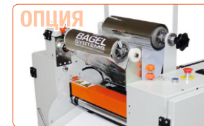
Цифровой модуль горячей штамповки. Многофункциональное устройство, позволяющее делать фольгирование, сплошное и выборочное лакирование
