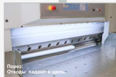
Trimmaster активируется: Передний стол открыт, планка для сброса отходов тоже открывается.
