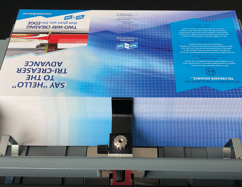
Инновационный модуль подачи позволяет работать со стопой бумаги высотой до 150 мм
